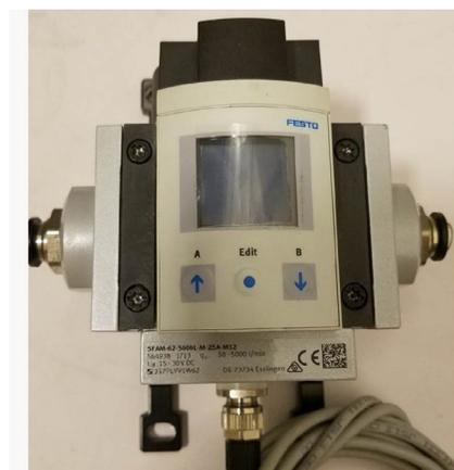
Contatore di flusso di aria compressa (NI)
