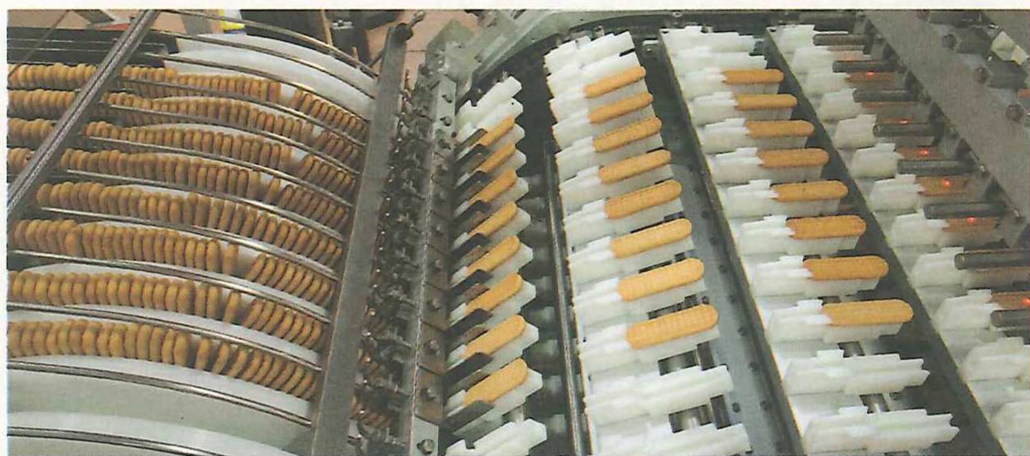
Il caricatore per le monoporzioni, con cambio di formato rapido da 8 a 12 pezzi
